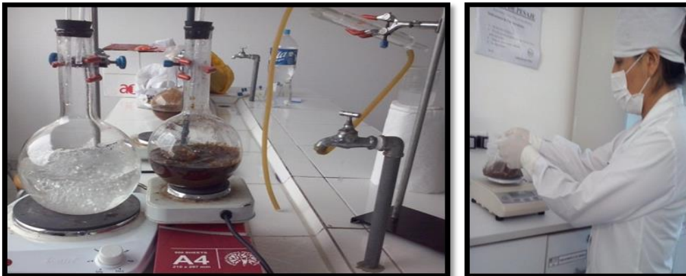
Foto 2. Se instala el equipo de destilación por arrastre de vapor, luego se inicia la extracción del aceite del Syzygium aromaticum
