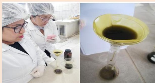
**Figura 5:** Filtración. Pasado una semana filtramos la muestra usando un embudo con papel filtro para obtener una muestra líquida. Fuente: Autor propio.
