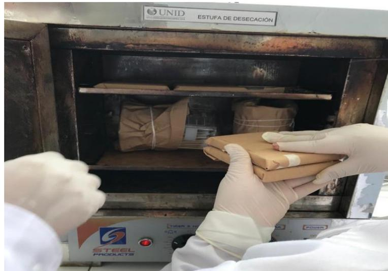
**Figura 14:** Esterilización de materiales. Materiales en proceso de esterilización. Fuente: Autor propio.
