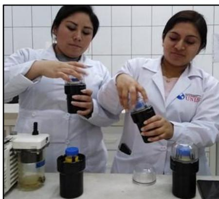
Figura 20. Preparación de la muestra. Separación de la fase metanólica por centrifugación a 15° por 10 min. Fuente: Fotos propias.
