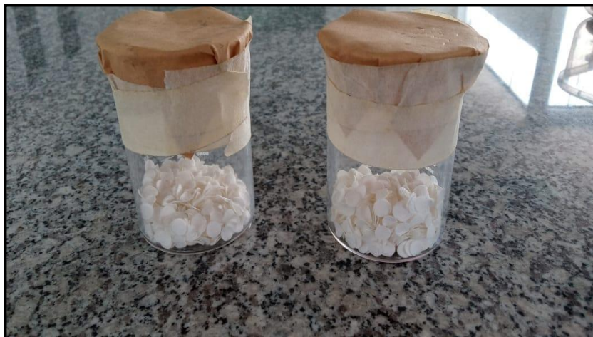
Figura SEQ Figura \* ARABIC 38: Discos de papel Watman. Para ser impregnados en las placas petri, para la identificación bacteriana
