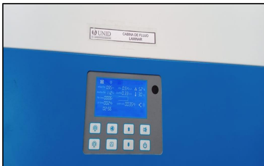
Figura SEQ Figura \* ARABIC 43: Cabina de flujo laminar BIOFASE. De la Universidad Interamericana para el Desarrollo, (Control de temperatura, humedad, luz, ventilador, movimiento de la puerta automático). Fuente: Elaboración propia.
